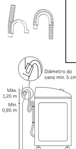
Nunca solte a mangueira de saída de água da abraçadeira fixada no gabinete, pois além de evitar cortes na mangueira, a abraçadeira garante a altura necessária para o funcionamento correto da Lavadora. Caso o comprimento da mangueira não seja suficiente para atingir o ponto de escoamento, procure a **Rede de Serviços Brastemp** - para a compra de uma mangueira disponível com 2,30 m de comprimento.
