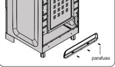
3) Posicione a peça nos furos sobre a mesa e deslize até alinhar os furos de fixação.
