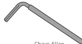
**01** Localize o parafuso de pressão na parte lateral do puxador e, com a chave solte o parafuso que está fixando o puxador.
