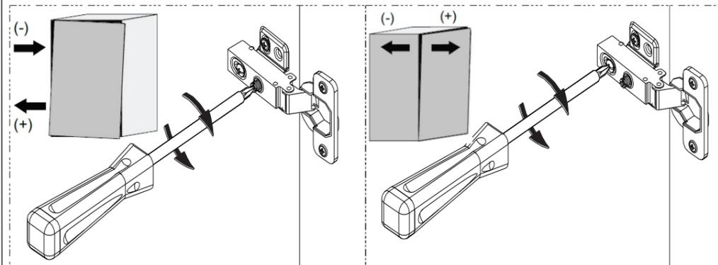
**Ajuste de altura    Parafuso de fixação após regulagem final**
