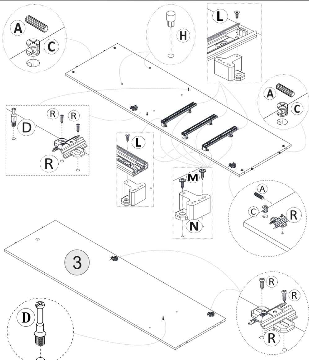
**PASSO 12: PRÉ MONTAGEM LATERAL DIREITA (19), LATERAL ESQUERDA (20);**
