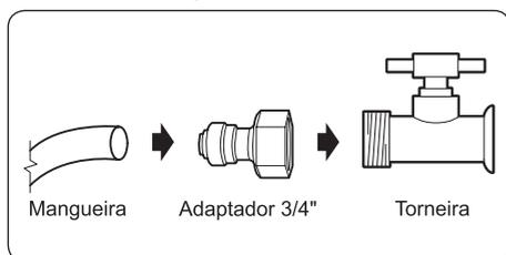
3. Coloque a mangueira na entrada de água do produto, até que a marca fique na borda do conector. Certifique-se que a mangueira não fique dobrada e conecte as travas azuis.
