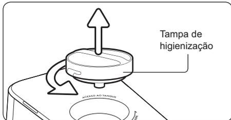
6. Desrosqueie a tampa do dreno, retire o tampão de silicone e, com auxílio de um recipiente, esvazie toda a água do tanque. Recoloque as tampas.
