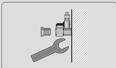
Conecte a mangueira ao conector de 1/4", retirando a porca e passando-a através da mangueira.
