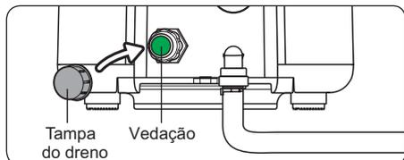
7. Após o procedimento de limpeza, caso seja necessário, corte um pedaço da mangueira, retirando a parte "arranhada" pela instalação anterior. Para remover a mangueira do produto, empurre-a para dentro, pressione a borda do conector rápido, e puxe a mangueira.
