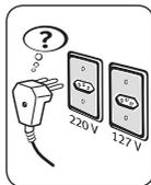
Este aparelho é vendido numa única versão que opera em 127 V ou 220 V automaticamente, sem necessidade de qualquer ajuste.
