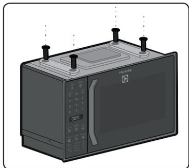
2. Instale o frame fixando os parafusos que vem com o produto nos lugares indicados.
