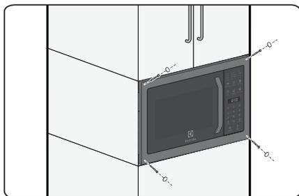
Parafusos 3x20 - 4 unidades, que fixam o frame no móvel.
