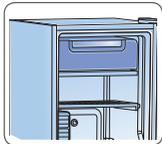
Este compartimento possibilita um congelamento mais rápido dos alimentos, devido a existência de uma tampa basculante que retém o ar frio.
