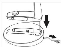
**02.** Inserir a haste na base, com a haste inclinada, conforme imagem.
