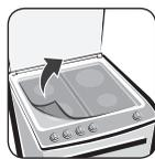
Após retirar a embalagem, remova as etiquetas dos vidros e com cuidado o filme plástico da mesa e demais partes, colocado para proteção do aço inoxidável. Não utilize o fogão com este plástico pois poderá danificar o inox. O calor derrete o plástico e sua remoção se torna muito difícil. Após a retirada do filme, executar a limpeza da mesa, conforme capítulo "Limpeza e Manutenção".
