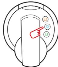
4. Quando as teclas acenderem de modo fixo, a máquina está pronta para ser usada.
