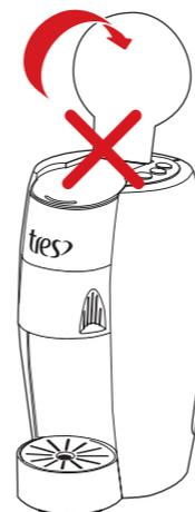
2. Se a alavanca for levantada durante a preparação de uma bebida, todas as teclas piscam em VERMELHO e é emitido um sinal sonoro. A distribuição é, imediatamente, interrompida. As teclas irão piscar alternadamente: LARANJA/VERMELHO, AZUL/VERMELHO E VERDE/VERMELHO e emitirá 10 sinais sonoros.
