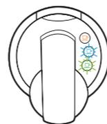
4. Pressione a tecla laranja e desligue a máquina retirando o plugue da tomada para confirmar.
