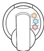
4. Após selecionar a temperatura desejada, retire o plugue da tomada, plugue novamente e, em seguida, levante e abaixe a alavanca. Agora, a nova temperatura está programada.
