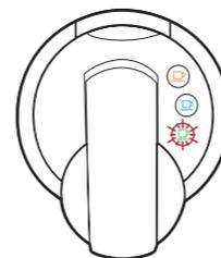
Para desativar o alerta, basta desligar a máquina retirando o plugue da tomada e ligar novamente colocando o plugue na tomada e abrindo e fechando a alavanca.
