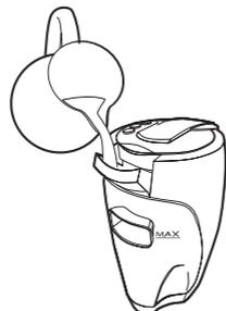
3. Pressione a tecla azul e aguarde a máquina terminar o ciclo de carga do circuito hidráulico.
