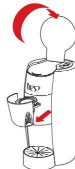
2. Coloque a cápsula no porta-cápsulas e insira-o na máquina.
