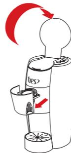
2. Coloque a cápsula no porta-cápsulas e insira na máquina.
