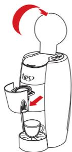
3. Insira a cápsula de retrolavagem, recoloque o porta-cápsulas e abaixe a alavanca.
