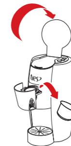
8. Utilize o reservatório de cápsulas usadas acoplável para descartar suas cápsulas durante o uso. Após terminar o uso de sua máquina, descarte as cápsulas e limpe o acessório.
