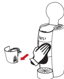
2. Retire o recipiente de recolhimento de gotas, a grade e o porta-cápsulas. Lave os componentes com água fria e esponja não-abrasiva. Para desmontar o porta-cápsulas, consulte o passo a passo na página 22.
