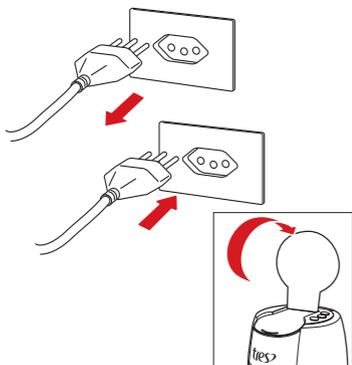
2. Mantenha pressionadas as teclas azul e verde e plugue a máquina na tomada. Abaix e levante a alavanca.
