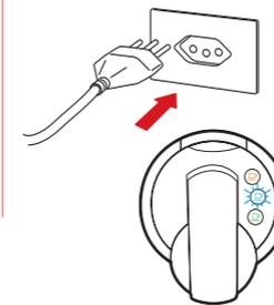
3. 2ª fase: aperte a tecla azul - irá piscar VERDE e VERMELHO, alternadamente. A máquina irá circular água no sistema em intervalos. É necessário colocar um recipiente vazio abaixo do porta-cápsulas. A máquina produzirá um aviso sonoro quando o processo estiver finalizado.
