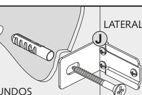
Obrigatória a fixação do módulo com suporte aéreo na parede
