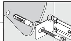
Fixe a cantoneira na lateral. Posicione o módulo e através das cantoneiras, fixe na parede com bucha e parafuso.
