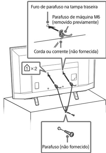
O comprimento do parafuso de máquina M6 difere de acordo com o diâmetro da corda ou corrente. Veja a ilustração a seguir.
