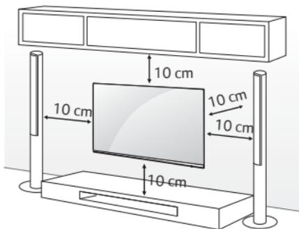
Instale o Suporte em uma parede sólida perpendicular ao piso. Ao instalar em outros materiais ou posição, poderão ocorrer acidentes ou danos. Evite prejuízos desnecessários, falando com seu revendedor e contratando somente pessoal qualificado para efetuar a instalação do aparelho na parede.
