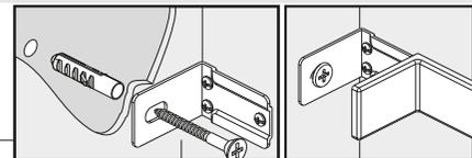
Fixe a cantoneira na lateral. Posicione o módulo e através das cantoneiras, fixe na parede com bucha e parafuso.
