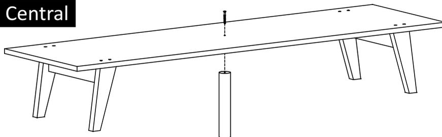
Marcar o centro da peça (comprimento)
