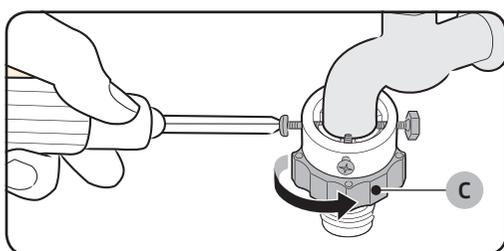
4. Insira o adaptador na torneira de água e aperte os parafusos ao levantar o adaptador.
