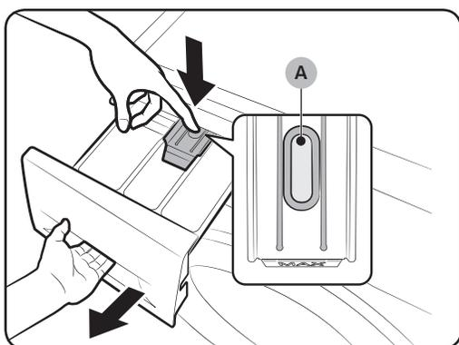
1. Enquanto pressiona e segura a **alavanca de liberação (A)** na parte interna do compartimento, deslize-o para abrir.
