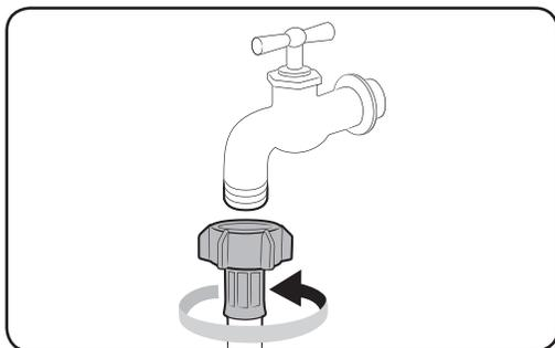
8. Abra a torneira de água e verifique se há vazamentos em torno das áreas de conexão. Caso haja vazamentos, repita os passos anteriores.
