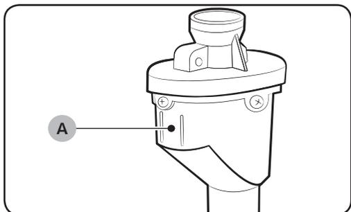
A mangueira aqua alerta os usuários sobre o risco de vazamentos de água. Ela detecta o fluxo de água e fica vermelha no **indicador (A)** central em caso de um vazamento.
