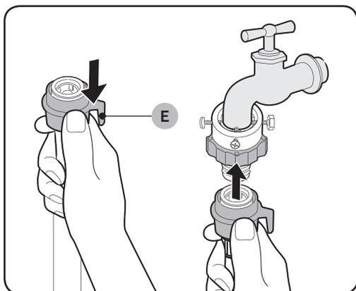
6. Ao pressionar a **peça (E)**, conecte a mangueira de água ao adaptador. Então solte a **peça (E)**. A mangueira se conecta ao adaptador com um som de clique.
