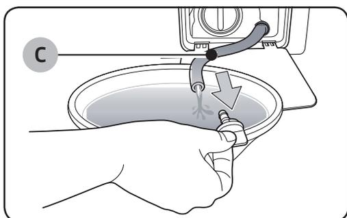
4. Abra a tampa do cano e deixe a água no **cano de drenagem de emergência (C)** fluir para dentro do recipiente.
