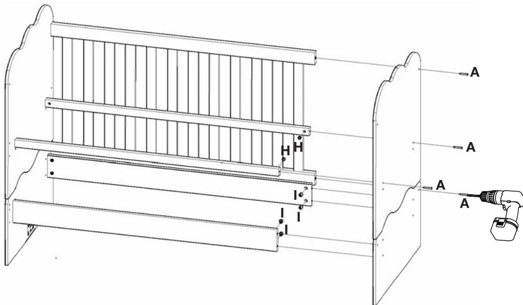
4 Utilizar a parafusadeira com o torque em 15 para fixar a grade.
