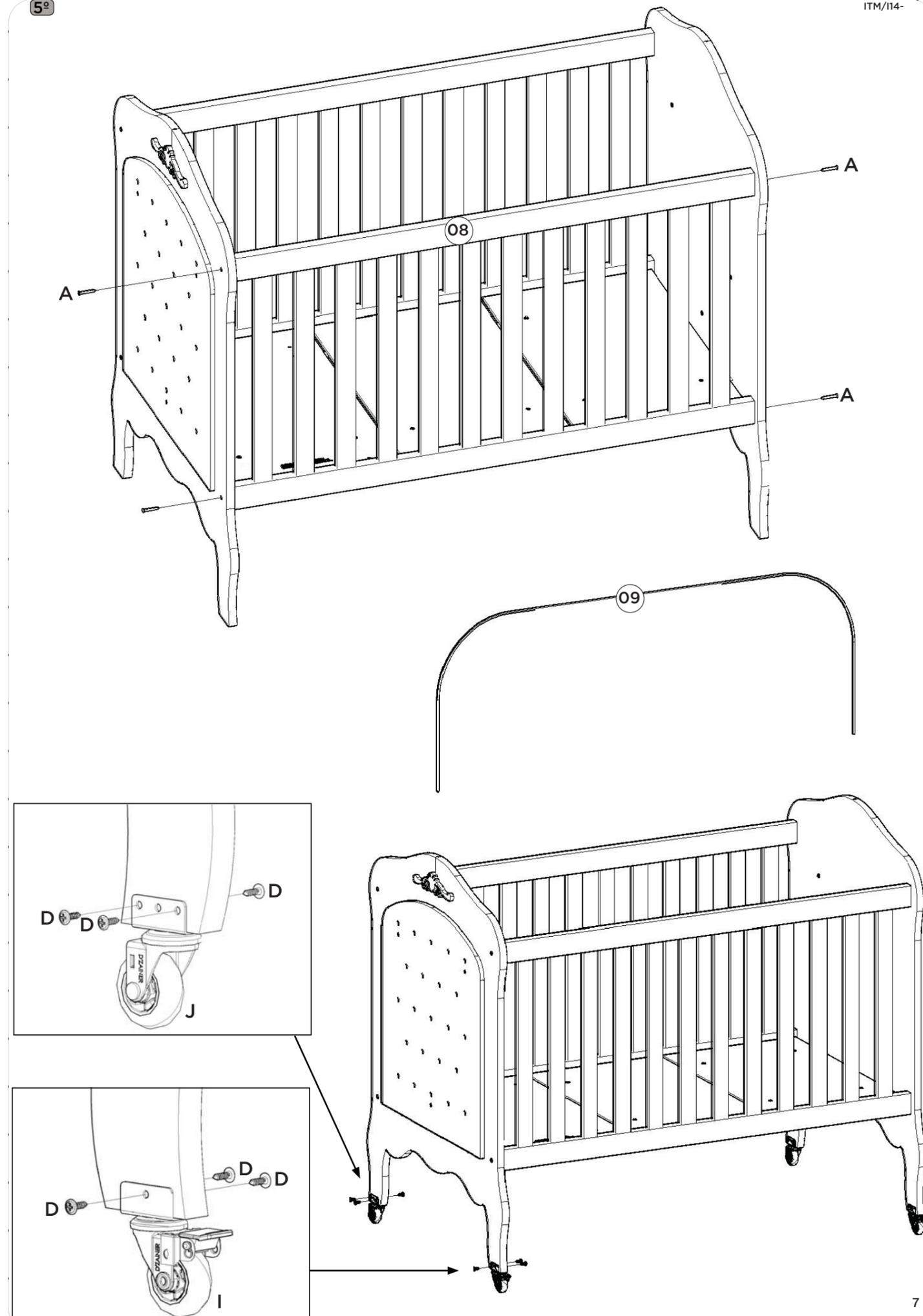
Utilizar a parafusadeira com o torque em 15 para fixar o lastro.
