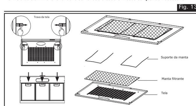
Recoloque a tela metálica em sua posição, empurrar as 2 travas ao mesmo tempo no sentido inverso para travar a tela metálica.
