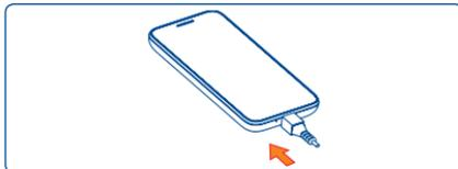
Conecte o carregador da bateria ao seu telefone e conecte-o à tomada, respectivamente.
