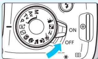
**Coloque o interruptor de alimentação na posição <ON>** (p.39).
