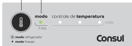
Para alterar para o modo **freezer**, pressione por 2 segundos a tecla controle de temperatura.
