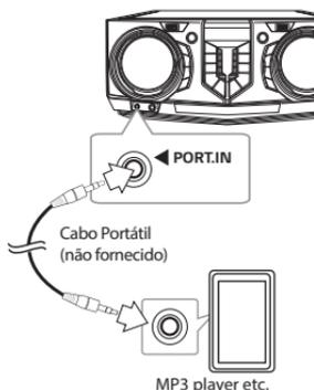
Na unidade, conecte seu dispositivo portátil (MP3 player e etc.) à conexão **PORT. IN** usando um cabo portátil (**Tipo P2**).
