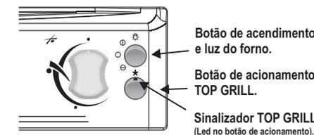
A potência da resistência do forno (topgrill) é de 700 Watts.
