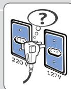
Para sua segurança, solicite a um electricista qualificado que verifique a condição da rede elétrica do local de instalação da secadora. Para mais informações entre em contato com o Serviço Autorizado Electrolux.
