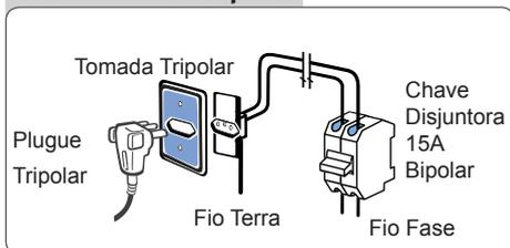
Para a secadora 220V (entre duas fases), utilize um disjuntor bipolar de 15A e uma tomada tripolar de 20A.
