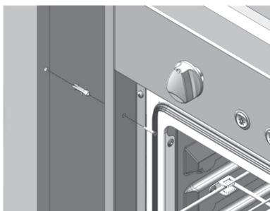
Obs: Para fixação do forno em nichos de mármore ou granito, deverá ser utilizada uma bucha de 6mm. (Fig 02)
