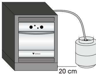
Se o botijão ficar a mais de 120 cm do forno (exemplo: na área de serviço), a instalação deverá ser feita conforme norma da ABNT, NBR 13932 (Instalações internas para GLP.)
