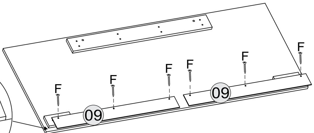
Alinhar a Nº 09 Travessa Central, pela a peça Nº 08 Apoio do Painel para deixar a passagem de fiação no centro do painel.
