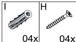
**Obs:** Utilizar Broca de 8mm, para fixar o acessório ( I ) Bucha Plástica na parede.
