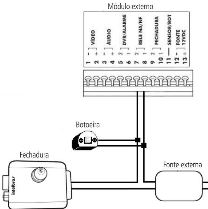
*Instalação de botoeira na fechadura 2*
