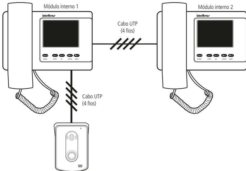
Instalação com 2 módulos internos e 1 módulo externo
