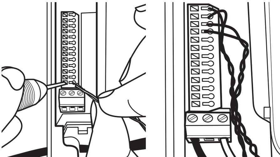
5. Certifique-se de que todos os cabos utilizados na instalação estejam devidamente presos ao conector e verifique se a polaridade dos cabos está correta;
