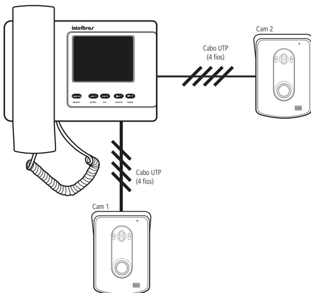
Instalação com 1 módulo interno e 2 módulos externos
