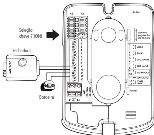
Instalação de fechadura com botoeira
