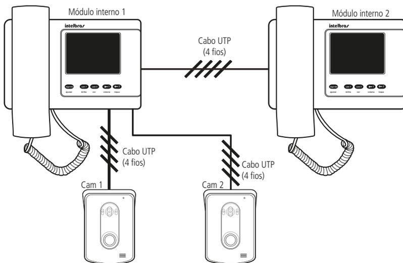
Instalação com 2 módulos internos e 2 módulos externos
