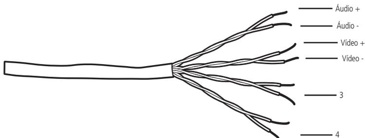
Instalação até 100 metros com cabo UTP
