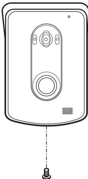
**Atenção:** » Não esqueça de inserir todos os cabos da instalação pela passagem de cabos da tampa posterior do produto que será parafusada no local da instalação.
