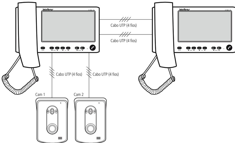
Instalação com 2 módulos internos e 2 módulos externos
