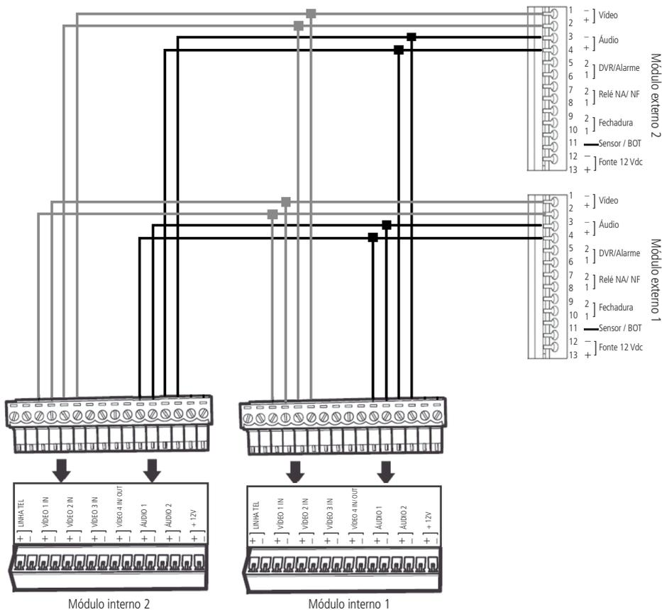
Conexão 2 módulos internos e 2 módulos externos
