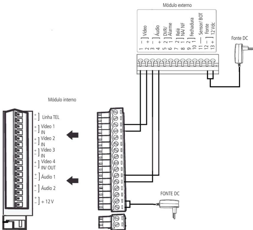
Instalação básica com fonte DC
