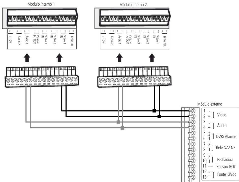
Conexão com 2 módulos internos e 1 módulo externo
