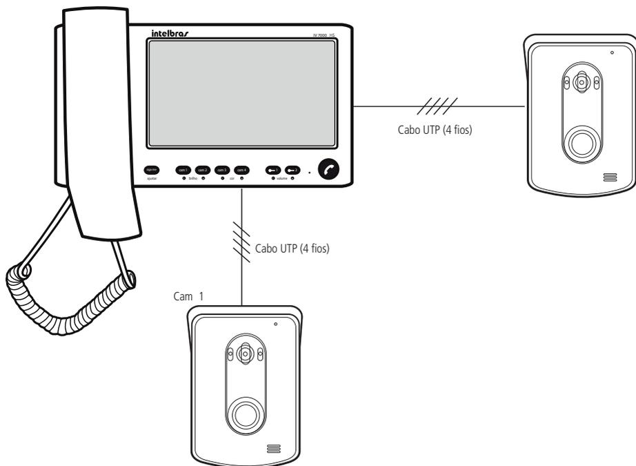
Instalação com 1 módulo interno e 2 módulos externos
