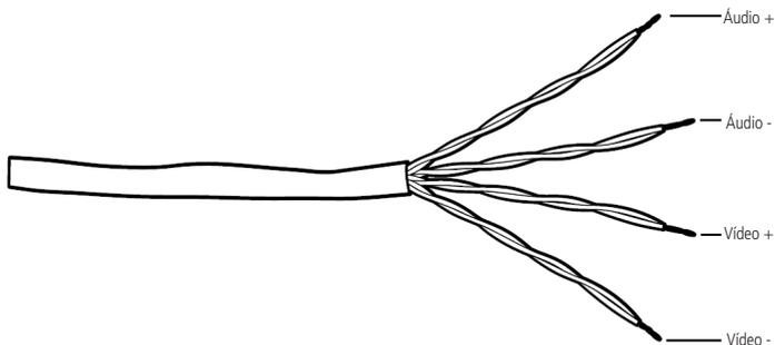
Instalação entre 50 e 100 metros com cabo UTP
