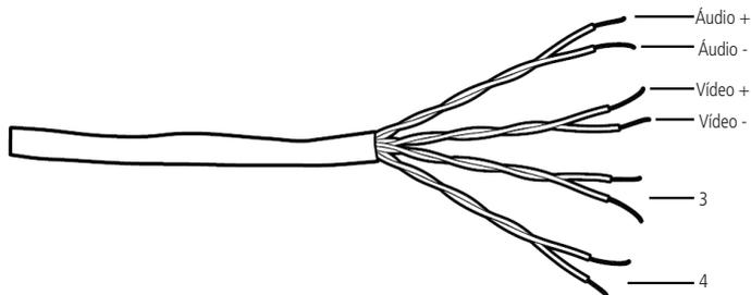
Instalação até 50 metros com cabo UTP
