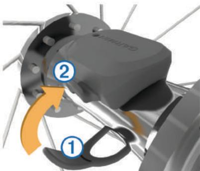
O sensor pode ser inclinado quando instalado em um centro assimétrico. Isso não afeta o funcionamento.
