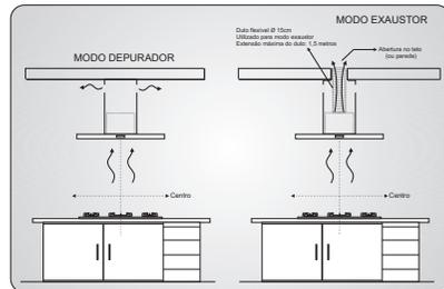
NOTA: Para fixação do produto, centralizar a coifa com o fogão. Com uma trena, achar a altura entre o fogão e a base da coifa, conforme indicado neste manual (65 a 80cm).
