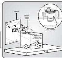
Preparar os fios para conectar o produto na rede elétrica. Os fios e tomada desta conexão deverão ficar alojados dentro dos dutos de inox da coifa. Contatar um electricista para a melhor forma de instalação elétrica do produto, lembrando que é importante que a residência possua rede de aterramento, pois o produto já sai de fábrica com plugue 3 pinos (pino terra). Recomendamos que a instalação seja feita através da Rede de Postos Autorizados Fischer.
