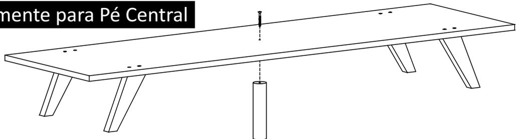
Marcar o centro da peça (comprimento)
