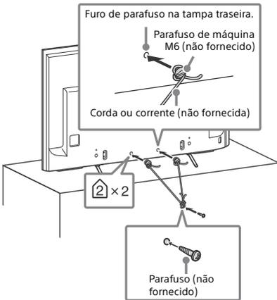
O comprimento do parafuso de máquina M6 difere de acordo com o diâmetro da corda ou corrente. Veja a ilustração a seguir.
