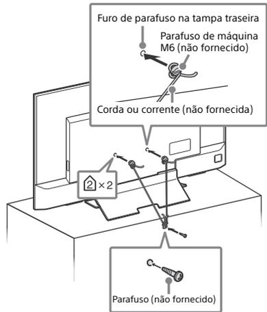
O comprimento do parafuso de máquina M6 difere de acordo com o diâmetro da corda ou corrente. Veja a ilustração a seguir.
