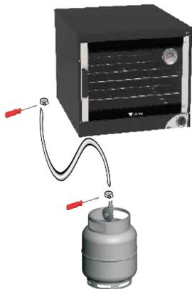
1- Coloque abraçadeira de metal na ponta da mangueira, encaixada no ponto de entrada de gás do forno.
