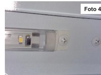
5º - Com a nova lâmpada de led, encaixe novamente o conector elétrico da lâmpada (**Foto 2**) com o da expositora, após encaixe a lâmpada de led na "presilha" da eletro-calha (**Foto 3**), fixe o parafuso da caixa de proteção da fiação (**Foto 1**).
