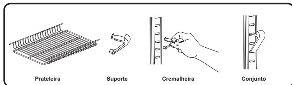
No modelo VV300 deve-se efetuar a montagem das prateleiras encaixando-as junto aos trilhos do gabinete interno, conforme posicionamento mais adequado das bebidas a serem armazenadas (ver figura abaixo).
