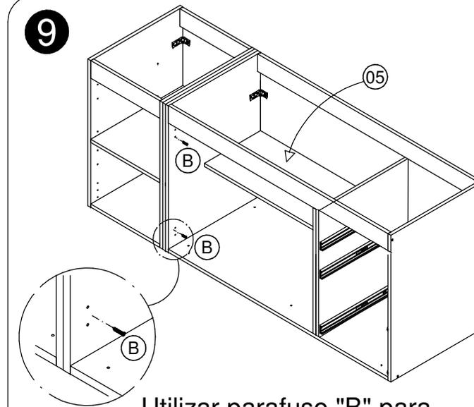
Utilizar parafuso "B" para união de módulos.
