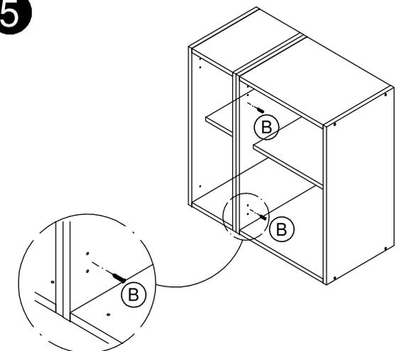
Utilizar parafuso "B" para união de módulos.
