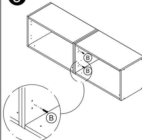
Utilizar parafuso "B" para união de módulos.
