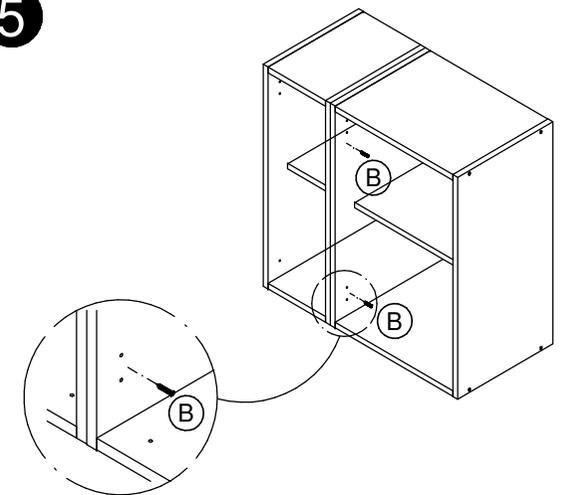
Utilizar parafuso "B" para união de módulos.
