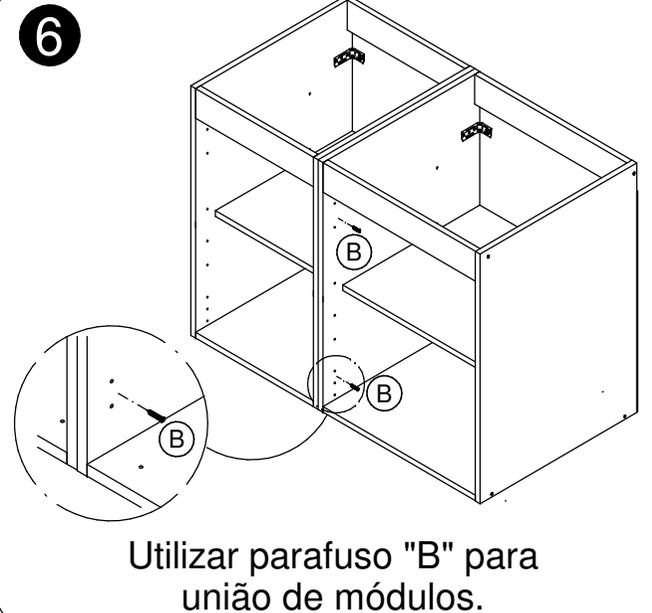
Utilizar parafuso "B" para união de módulos.
