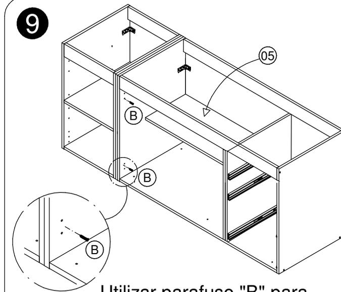
Utilizar parafuso "B" para união de módulos.
