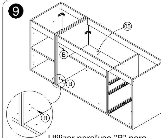
Utilizar parafuso "B" para união de módulos.
