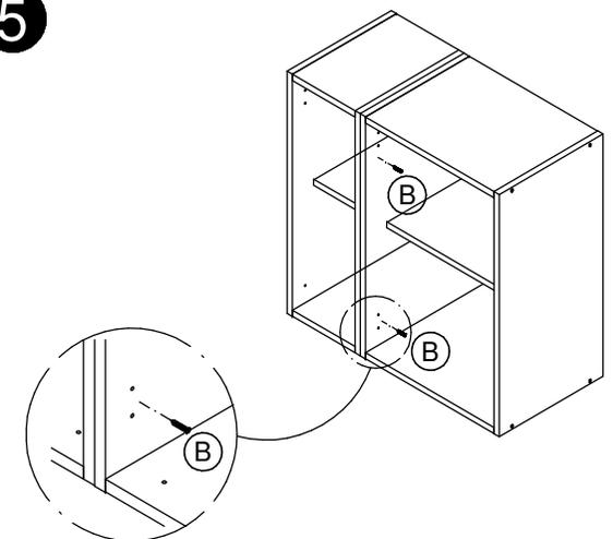
Utilizar parafuso "B" para união de módulos.
