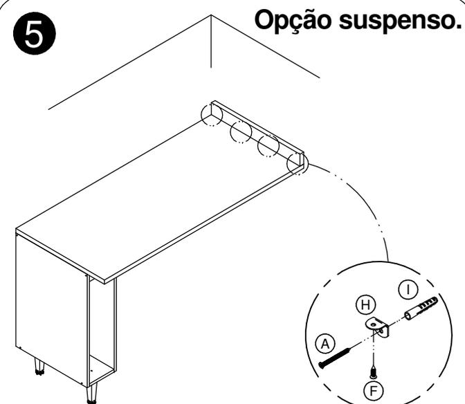
Fixação na parede.
