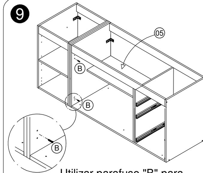
Utilizar parafuso "B" para união de módulos.
