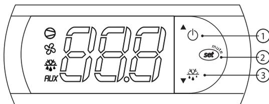
**Tecla 1** – Função: aumentar a temperatura desejada no interior do produto. Atenção se pressionada por mais de 3 segundos, ela desliga/liga o sistema de refrigeração da cervejeira.
