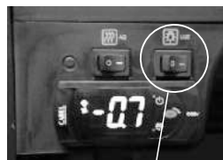
INTERRUPTOR DA ILUMINAÇÃO INTERNA
