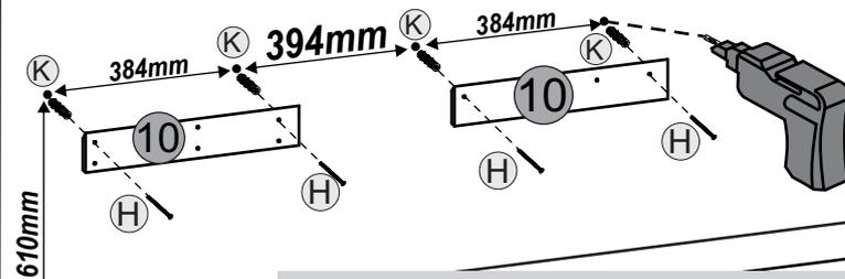
**Obs.:** Encaixe a bancada na peça Nº 10 Suporte Inferior Painel / Parede
