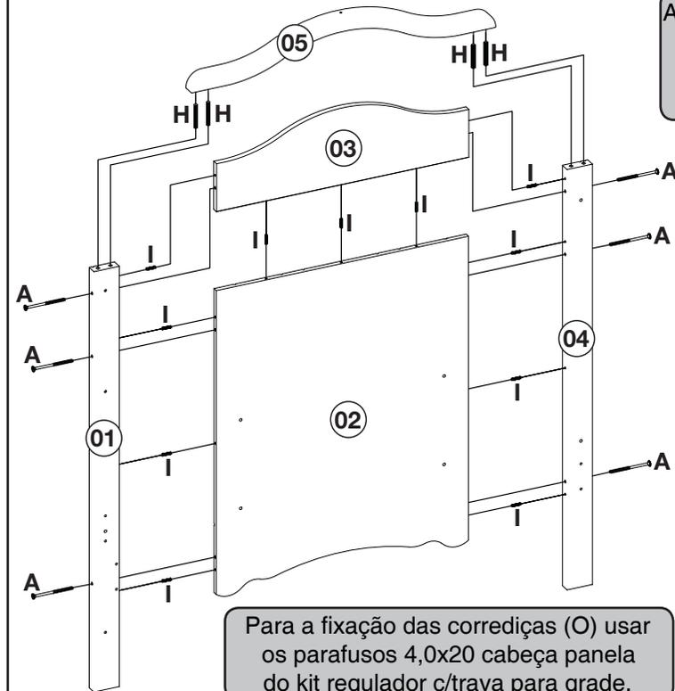
Para a fixação das correias (O) usar os parafusos 4,0x20 cabeça panela do kit regulador c/trava para grade.
