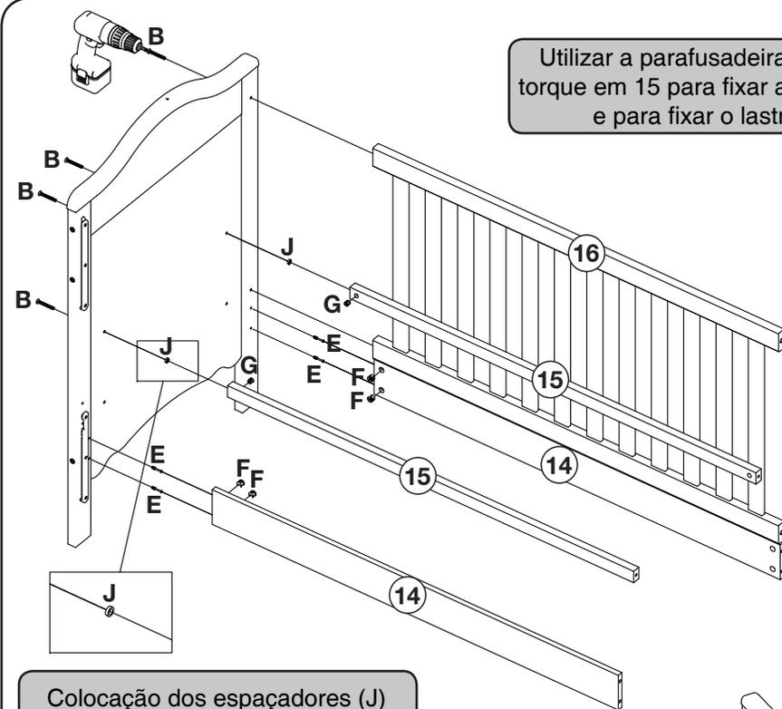
Utilizar a parafusadeira com o torque em 15 para fixar as grades e para fixar o lastro.
