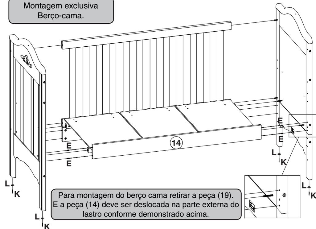
Para montagem do berço cama retirar a peça (19). E a peça (14) deve ser deslocada na parte externa do lastro conforme demonstrado acima.
