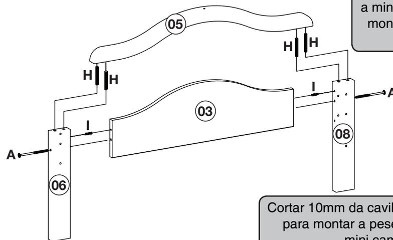
Cortar 10mm da cavilha 8x60mm (H) para montar a peseira na opção mini cama.
