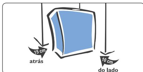
Deixe um espaço livre de 15 centímetros na parte traseira e de 10 centímetros nas laterais do aparelho para permitir a correta circulação do ar e evitar o superaquecimento.
