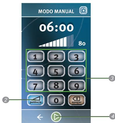
O Modo manual permite a programação de tempo e potência de seu micro-ondas.
