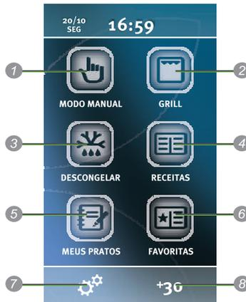
1. Utilize o teclado numérico para programar tempo e potência em seu micro-ondas com a função "Modo Manual".
