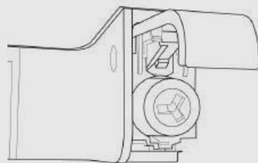
1. Levante a tampa do filtro para abrir. O filtro será liberado e ejetado quando a tampa for aberta.
