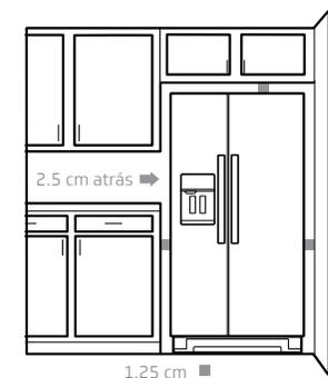
Quando instalar o refrigerador próximo a uma parede fixa, deixe uma distância mínima de 5 cm em cada lado para abrir as portas.
