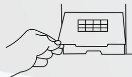
3. Encaixe o filtro no compartimento, posicionando-o pelas abas laterais e empurrando.
