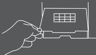
3. Encaixe o filtro novo no compartimento, posicionando-o pelas abas laterais e empurrando.
